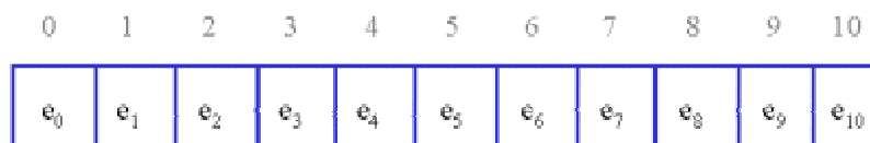
Figur 21.1 Et array med 11 elementer indiceret fra 0 til 10
